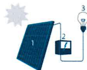
1. Zonnepaneel 2. Omvormer 3. Eigen elektriciteitsverbruik
